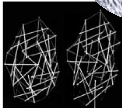
3. Le raidissement linéaire, observé dans les organes tels que les muscles et les cellules, résulte de la réorientation (représenté ci-dessus) des fibres dans les structures de tenségrité. En haut à droite, les fibres du cytosquelette d'une cellule.
