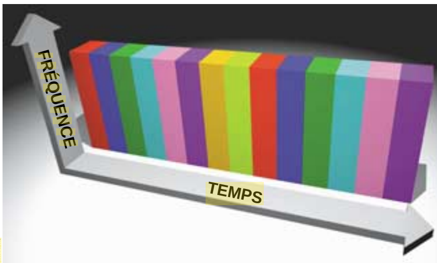
6. L'ACCÈS MULTIPLE PAR RÉPARTITION DU TEMPS est une autre technique de partage du spectre radio. Chaque utilisateur (couleurs) émet ou reçoit pendant une fraction de milliseconde (barres verticales). Les données numériques provenant de chaque émetteur sont comprimées et envoyées simultanément sur plusieurs fréquences pendant cet intervalle de temps. Le récepteur sait précisément quand les signaux sont émis ou reçus, et il peut donc les séparer.
