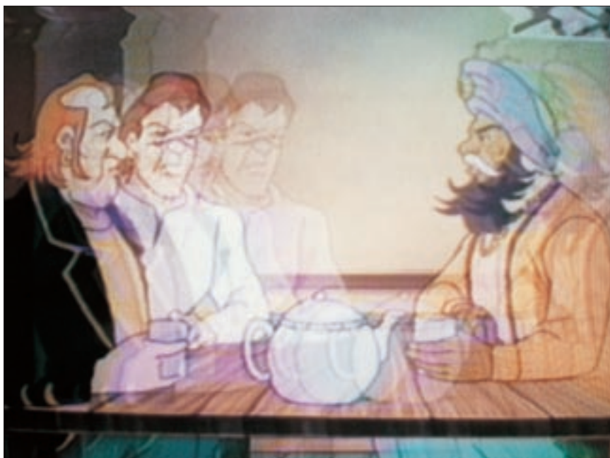
5. LES ECHOS apparaissent, en transmission analogique, lorsqu'un récepteur capte le signal de deux émetteurs terrestres proches. Comme ces deux émetteurs ne sont pas à la même distance, les deux signaux reçus sont décalés, ce qui provoque les échos. En télévision numérique, le problème sera résolu par l'utilisation de la transmission multiporteuse.
