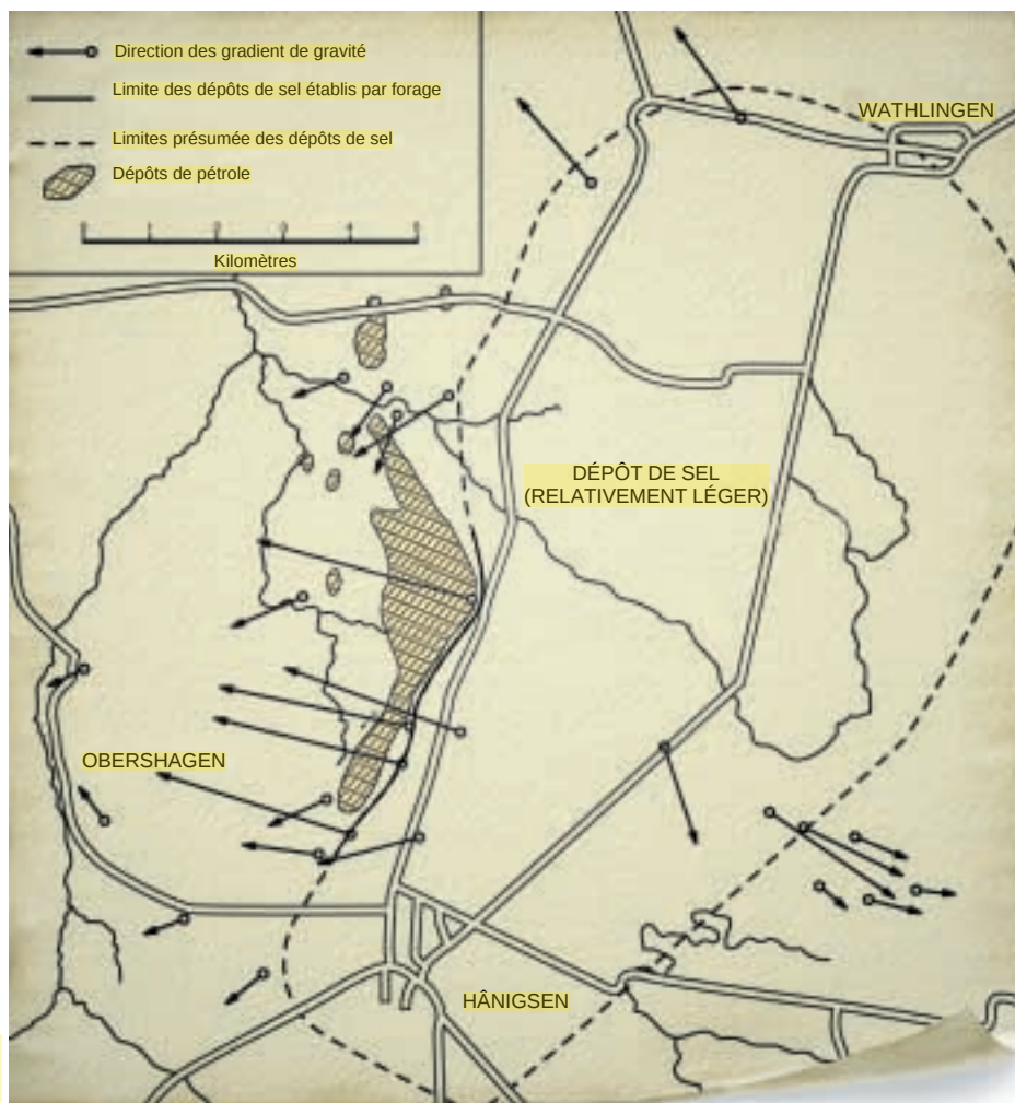
2. UNE ÉTUDE GÉOPHYSIQUE réalisée en 1917 près de Hanovre, à l'aide d'une balance de torsion, prouva que l'on pouvait repérer des dépôts de sel souterrains grâce à la gradiométrie gravitationnelle. Ces formations salifères, moins denses que les roches environnantes, indiquent généralement que des gisements de gaz et de pétrole (zones hachurées) sont situés à proximité.
