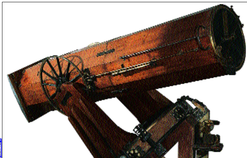
4. CE TÉLESCOPE EQUIPE D'UN MIROIR de 20 centimètres de diamètre (à gauche) fut réalisé par Foucault, qui appliqua une mince couche d'argent sur la face avant d'un bloc de verre poli, concave. Il mit au point des techniques pour fabriquer des miroirs bien plus grands, ouvrant ainsi la voie aux télescopes à réflexion géants. Le plus grand des télescopes de Foucault (ci-dessus), qui possède un miroir en verre argenté de 80 centimètres de diamètre, fut réalisé à Paris au début de 1862. Il fut ensuite installé à l'Observatoire de Marseille, où il fut utilisé pendant une centaine d'années. Ce télescope fait aujourd'hui partie du patrimoine historique français.
