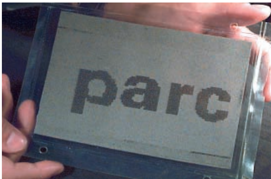
Le prototype de l'écran Gyricon , mis au point par la Société Xerox, a l'épaisseur de sept feuilles de papier et conserve l'affichage des mois durant, sans alimentation électrique.
