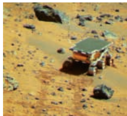
10. DES SOLS DE PLUSIEURS COULEURS sont révélés par les roues du robot. Sur cette photographie, le robot gravit la Dune de la Sirène, un empilement de matériaux recouvert de granules sombres de la taille de grains de sable. Les traces des roues découvrent aussi une poussière rouge vif et un sol rouge plus sombre (en bas, à gauche). Les planétologues déduisent de ces traces les propriétés des matériaux de surface.
