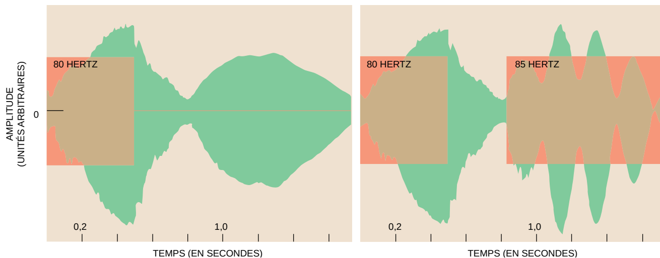
4. LA SIMULATION ACOUSTIQUE explique le phénomène de «dialogue» perçu sous deux fortes ponctuations rouges, dans la galerie Régnault de la grotte du Portel, en Ariège. Lorsqu'on émet brièvement un signal à 80 hertz (en rouge, signal envoyé par le haut-parleur), deux résonances aux fréquences proches de cette valeur sont excitées dans la galerie et un battement lent est pro-
