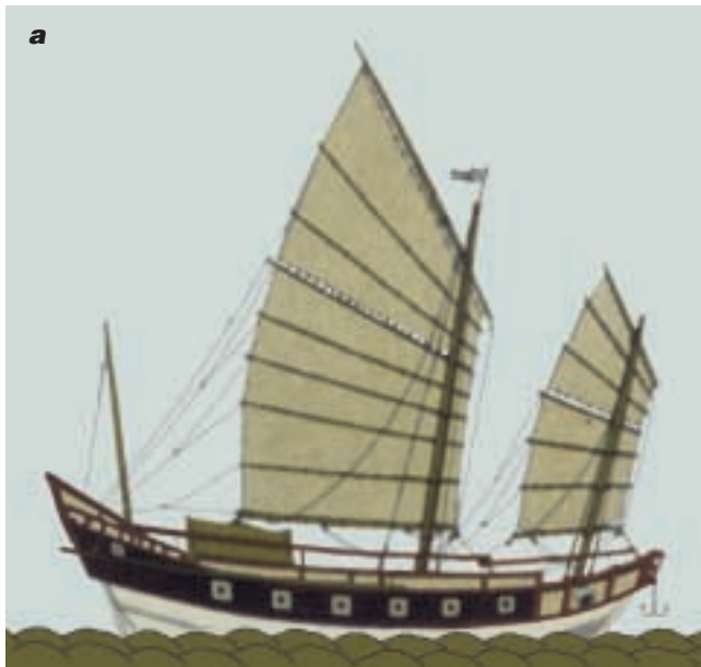
3. LA VOILE PRINCIPALE d'une jonque chinoise (a) pouvait être hissée ou abattue depuis le pont par un seul homme. Ces jonques furent les premières embarcations à remonter au vent. Composantes de la poussée de la voile sur une embarcation remontant au vent (b). Pour
