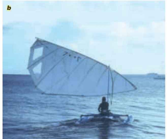
maran avec hydrofoil muni d'une voile polynésienne (b). Catamaran doté d'une véritable aile d'avion (c) : cette aile étant asymétrique, il faut la renverser verticalement lorsqu'on vire de bord. L'aileron
