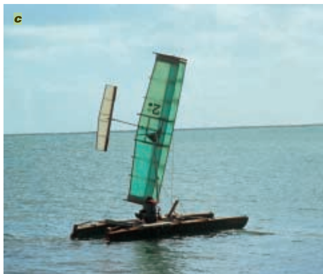
c blanc situé à l'arrière de l'aile, fonctionnant comme un gouvernail de profondeur d'un avion, permet d'ajuster l'angle au vent de l'aile principale. Zefyr (d) est la dernière version monoplan de Walker Wing-
