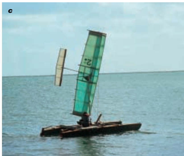
c blanc situé à l'arrière de l'aile, fonctionnant comme un gouvernail de profondeur d'un avion, permet d'ajuster l'angle au vent de l'aile principale. Zefyr (d) est la dernière version monoplane de Walker Wing-
