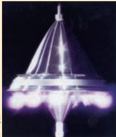
UNE MAQUETTE DE VAISSEAU SPATIAL PHOTONIQUE a déjà volé à 30 mètres de haut au cours d'essais ; elle était propulsée par un laser de dix kilowatts. Des systèmes plus grands devraient pouvoir être mis en orbite.
