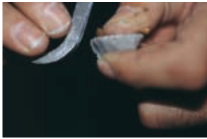
3. UNE LIME RECOURBÉE , dont l'acier riche en carbone est très dur, remplace avantageusement la marcassite dans un briquet à silex. Les étincelles embrasent un morceau d'amadou maintenu sur le silex (flèche).
