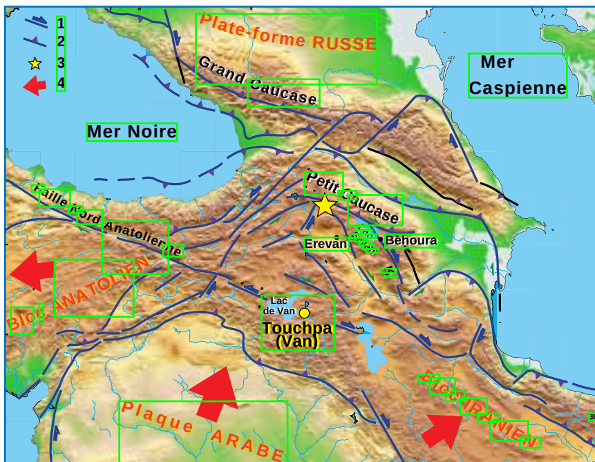
4. CARTE TECTONIQUE des régions du Caucase où sont représentées les principales failles actives de la région. 1. principaux décrochements, 2. failles inverses, 3. épicerentre du séisme de Spitak, 4. mouvements relatifs du Bloc arabe, de l'Anatolie et du Bloc iranien par rapport à l'Eurasie au Nord. La vitesse de convergence entre le Bloc arabe et l'Eurasie est d'environ 25 millimètres par an.
