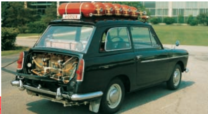
2. CETTE AUSTIN A40, construite en 1966, était équipée de piles à combustible alcalines fabriquées par la Société Union Carbide . Ce véhicule n'a qu'un intérêt historique : les piles occupaient presque tout l'intérieur de la voiture, de sorte que les réservoirs d'hydrogène comprimé devaient être installés sur le toit.
