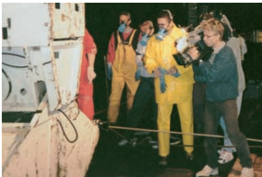
3. UN GRAPPIN TÉLÉCOMMANDÉ et équipé d'un système vidéo (à gauche) a remonté un échantillon de sédiment qu'il a prélevé dans un champ d'hydrate de méthane, au large de l'Oregon. Les morceaux (à droite) sont composés d'une alternance de couches
