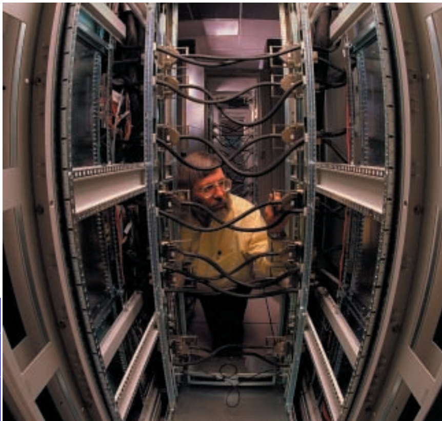
2. PLUSIEURS MILLIERS DE PROCESSEURS fonctionnent en parallèle dans ce superordinateur qui est utilisé pour la simulation des explosions nucléaires, aux Laboratoires Sandia. L'ordinateur est l'un des plus rapides du monde (le technicien représenté ici vérifie les câbles qui relient deux des huit blocs de l'ordinateur).
