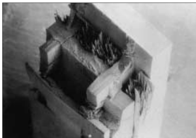
cohésion grâce aux fibres orientées dans le sens de l'épaisseur (à droite, grossi 19 fois). Ces deux photographies ont été prises au microscope électronique à balayage.
