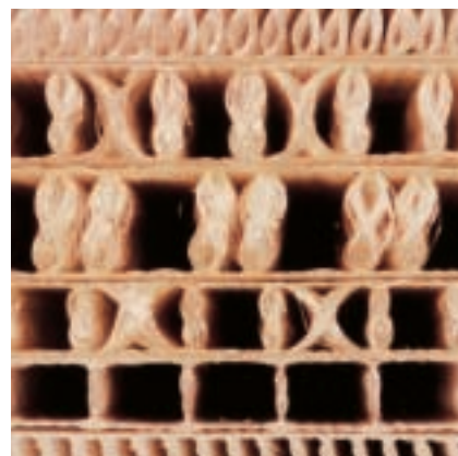
1. CE RÉSEAU TRIDIMENSIONNEL tissé est un renfort pour des composites de type «sandwich» : on l'imprègne d'une résine injectée à la fois par-dessus et par-dessous. Les deux couches de fibres externes sont fortement liées par un système de fils orientés dans l'épaisseur du tissu.
