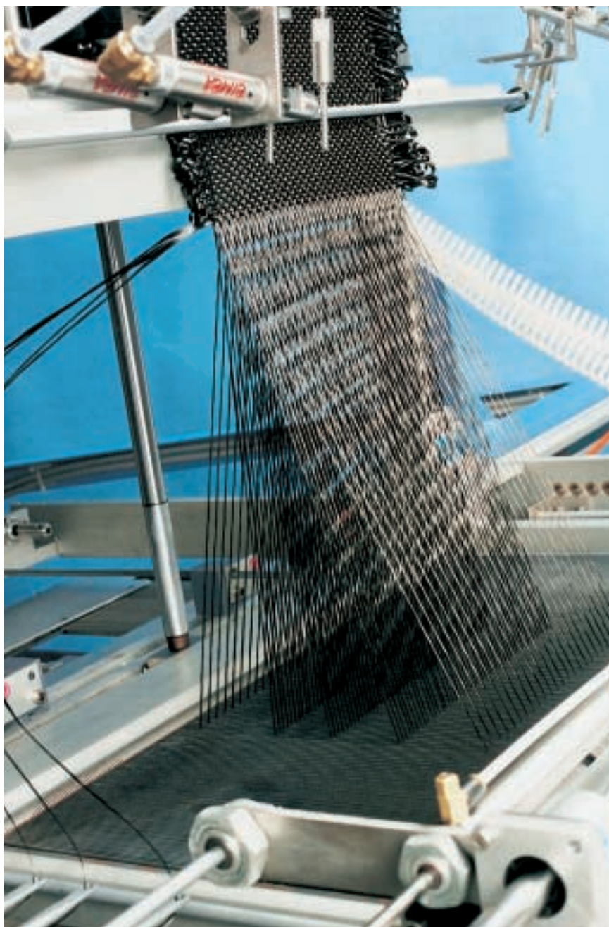
5. MACHINE DE TISSAGE tridimensionnel, où les fils de chaîne et de trame sont tissés sans courbure, ce qui compense leur faible proportion (par rapport à un tissu classique) et rend le textile plus résistant aux tractions longitudinales.
