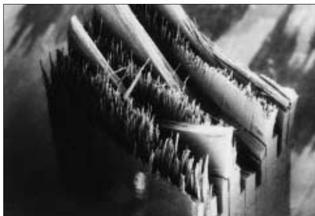
3. CE COMPOSITE À FIBRES CLASSIQUE, (à gauche, grossi 12 fois) présente plusieurs couches qui se séparent lors de la rupture. Au contraire, un composite à renfort textile tridimensionnel présente une meilleure
