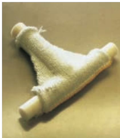
7. CE RACCORD EN T est rigidifié par un tricot tridimensionnel.
