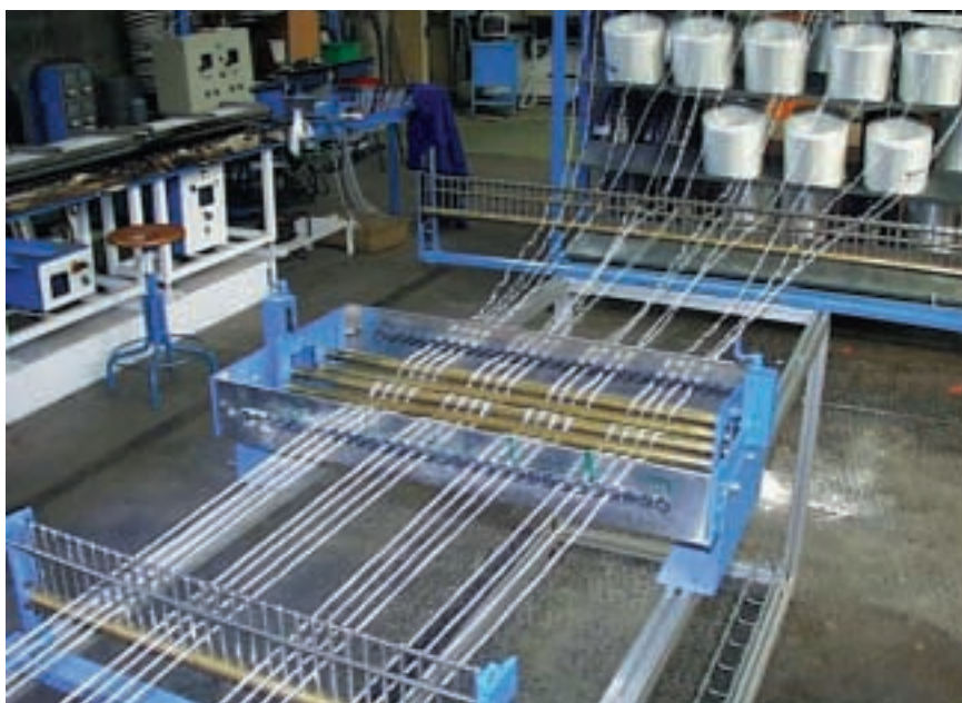
1. UTILISATION du Twintex pour la réalisation de profilés : les bobines du matériau sont tirées, et les fils mixtes, composés de filaments de verre mêlés à des filaments de polymère, sont tirés jusqu'à un four (non représenté), où la matrice polymère est fondue ; l'ensemble est alors poussé à travers des filières dont la section est celle du profilé recherché.
