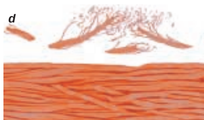
4. LES CELLULASES éliminent les «peluches», sur les vêtements. À mesure que les tissus s'usent (a à c), les fibres de surface se détachent et s'effritent ; «digérées» par les enzymes, elles se détachent et sont éliminées au lavage (d).
