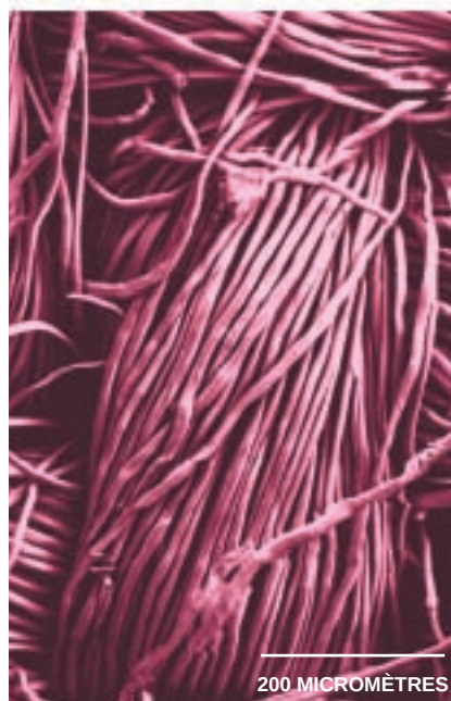
4. UNE ÉTOFFE peut être rendue plus douce au toucher par la création d'une pilosité de surface. Par exemple, le passage d'un papier d'éméri sur une toile de coton ( en haut, à gauche ) crée des petits poils ( en haut, à droite ). Pour des fibres de Lyocell® en cellulose ( en bas, à gauche ), un traitement mécanique suivi d'une dégradation enzymatique laisse quelques nanofibres ( en bas, à droite ) qui augmentent la douceur au toucher.
