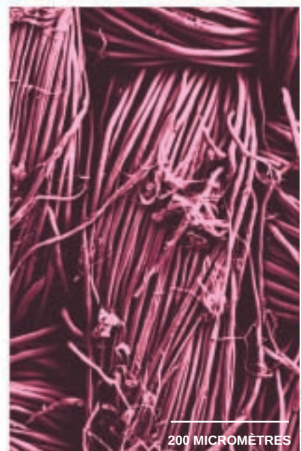
4. UNE ÉTOFFE peut être rendue plus douce au toucher par la création d'une pilosité de surface. Par exemple, le passage d'un papier d'éméri sur une toile de coton ( en haut, à gauche ) crée des petits poils ( en haut, à droite ). Pour des fibres de Lyocell® en cellulose ( en bas, à gauche ), un traitement mécanique suivi d'une dégradation enzymatique laisse quelques nanofibres ( en bas, à droite ) qui augmentent la douceur au toucher.
