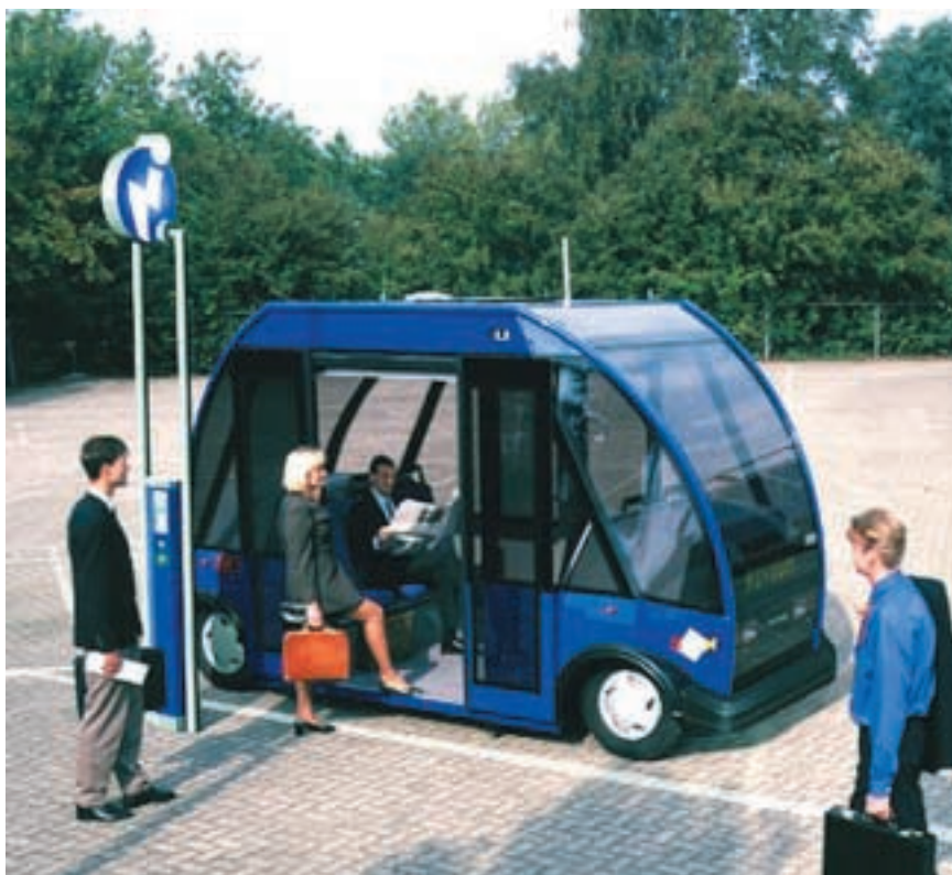
3. DES NAVETTES ROBOTISÉES transportent leurs passagers sur des trajets prédéfinis, en se repérant à des aimants enterrés.
