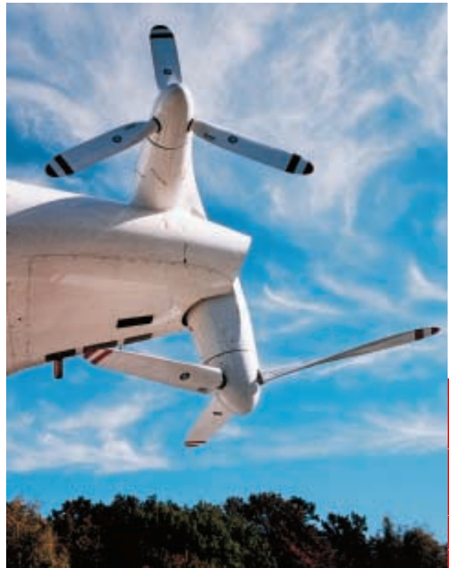
est munie d'une hélice arrière qui pivote vers le bas de 90 degrés et fait monter le vaisseau, ainsi qu'une hélice latérale pour faire décrire au zeppelin un cercle dont le centre est le nez de l'appareil.
