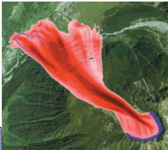
8. LA SIMULATION NUMERIQUE de l'avalanche de MontRoc, près de Chamonix, en Haute-Savoie, montre l'onde de pression (plus le rouge est foncé, plus la pression est forte) de la neige détachée de la zone de départ (en bleu, en bas à droite). L'écoulement dense, dont la zone d'arrêt, dans le village même, est marquée en violet, a suivi deux couloirs différents.
