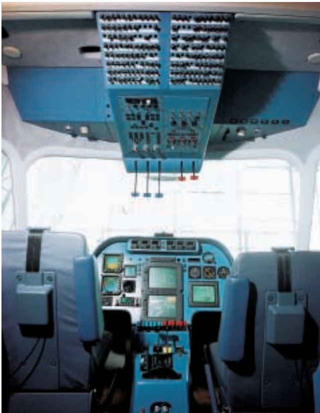
2. LE COCKPIT des nouveaux zeppelins (à gauche) comporte des instruments de navigation modernes, ainsi que des systèmes électroniques de commande des systèmes de vol. La queue (à droite)
