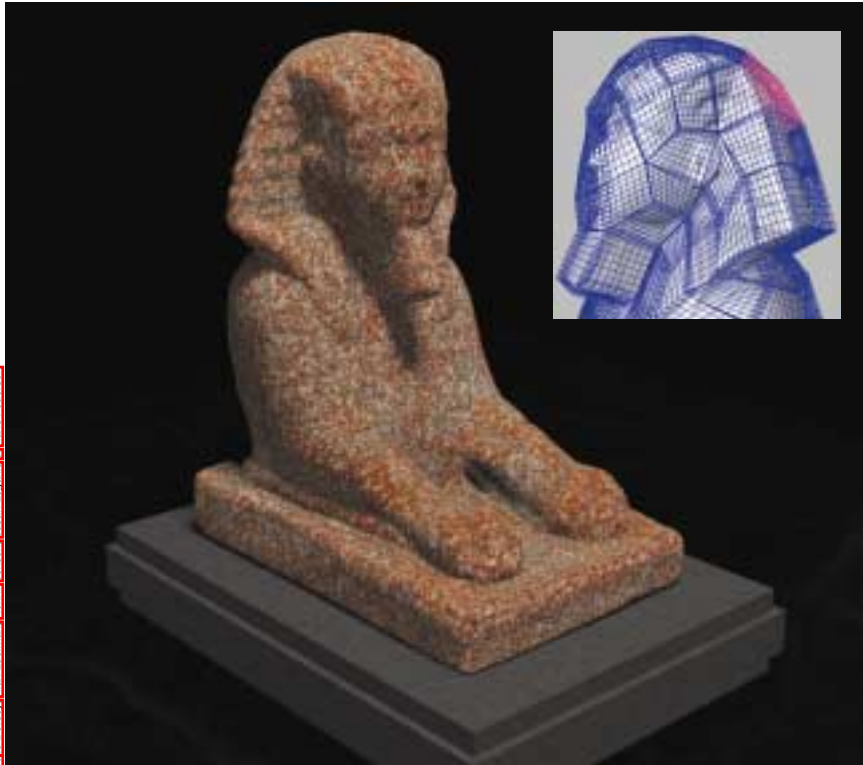
4. L'USURE D'UN SPHINX DE GRANIT est simulée à l'aide d'une coque épaisse (cartouche). On a calculé comment l'eau et les molécules qui y sont dissoutes pénètrent la coque et réagissent chimiquement avec la pierre ; simultanément, des sels recristallisent dans la croûte érodée.
