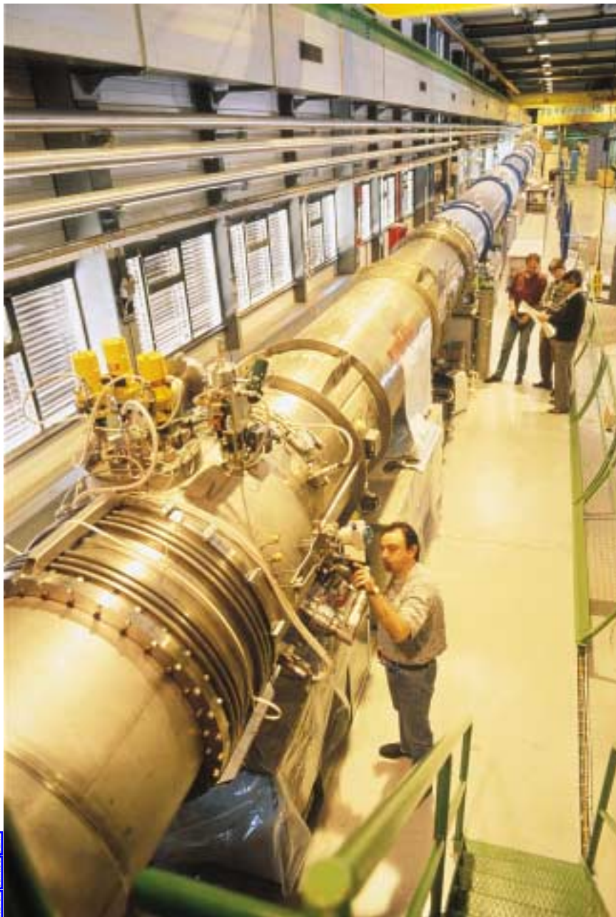
2. LE TRONÇON D'ESSAI d'un aimant supraconducteur a été réalisé dans le hall d'assemblage ; 1 232 aimants de ce type dévieront les deux faisceaux de protons accélérés par le LHC et leur feront suivre une trajectoire circulaire dans le tunnel de l'accélérateur.
