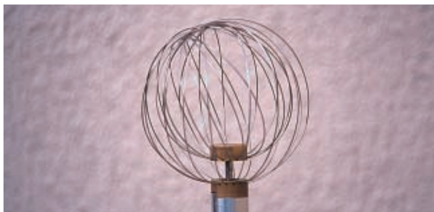
2. La formation d'une sphère double à partir d'une sphère simple que l'on aplatit en faisant coulisser vers le haut le cylindre C sur la tige T .
