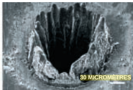
3. LE MICRO-USINAGE LASER met à profit les propriétés des impulsions les plus courtes. Une impulsion de 200 femtosecondes produite par ablation produit un trou parfaitement lisse dans l'acier (à gauche). Sans techniques particulières, des impulsions d'une puissance
