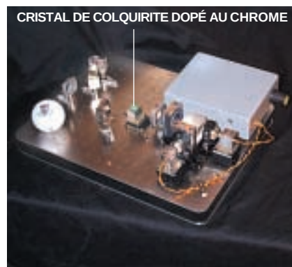
6. LE LASER À FOCALISATION RÉSONANTE DE KERR produit des impulsions ultracourtes de forte puissance. Un faisceau laser vert excite le cristal de saphir dopé au titane, qui produit et amplifie le faisceau rouge à l'intérieur de la cavité définie par les quatre miroirs. L'ouverture du miroir semi-transparent supprime la partie continue du laser et le faisceau traverse des prismes qui corrigent la dispersion. La position de l'ouverture sur l'un des miroirs règle la fréquence de la lumière en ne laissant passer que la portion souhaitée du spectre de la lumière rouge. Les impulsions sortent par le miroir semi-transparent. Des appareils compacts ont révolutionné les applications potentielles des lasers à impulsions ultracourtes. Le dispositif représenté ici (photographie à droite) tiendrait sur une page de cette revue. Il est alimenté par de simples piles LR6, et délivre des impulsions lumineuses d'un demi-kilowatt (une balle de golf (la sphère blanche à gauche du dispositif) est représentée pour visualiser l'échelle).
