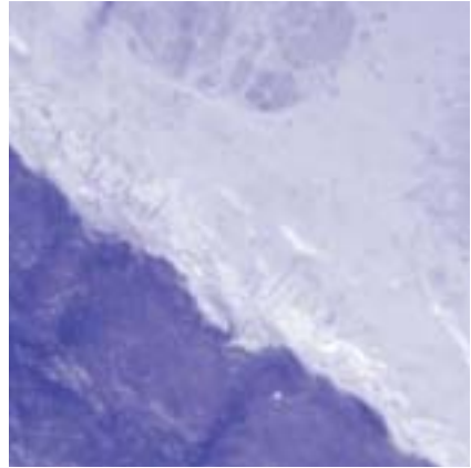
Le bioverre (en haut) favorise la formation d'une couche d'apatite (plus claire, au centre), ciment provisoire avec l'os (en foncé).
