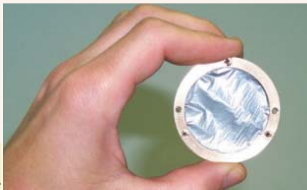
La cible contient une très fine feuille d'atomes de calcium. Une fois en place, elle sera bombardée par les particules du faisceau.
