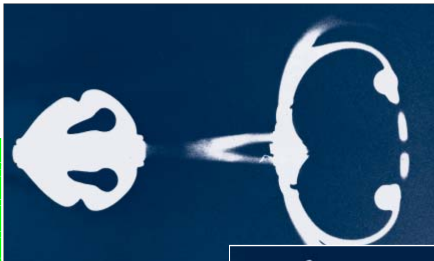
2. RADIOGRAPHIE DE TIZONA ET DE SA POIGNÉE. On constate que la prolongation du manche et la mise en place de la poignée actuelle ont fragilisé la structure (zone noire entre le pommeau et la poignée).
