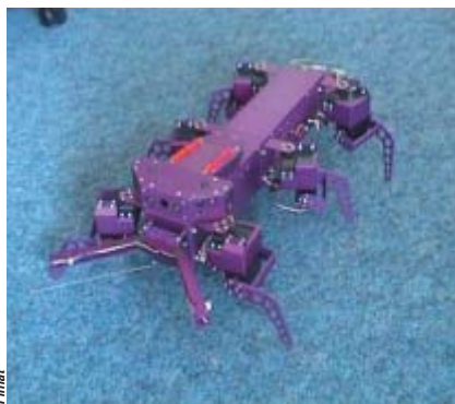
8. CE ROBOT HEXAPODE est commandé par un réseau de neurones qui a été créé par un programme de développement, lui-même découvert par un processus évolutionniste. Ce programme incluait des instructions qui provoquaient la création, la suppression et la modification de neurones ou de leurs connexions. Le robot marche à la façon d'un insecte (rythme tripode) et évite les obstacles.
