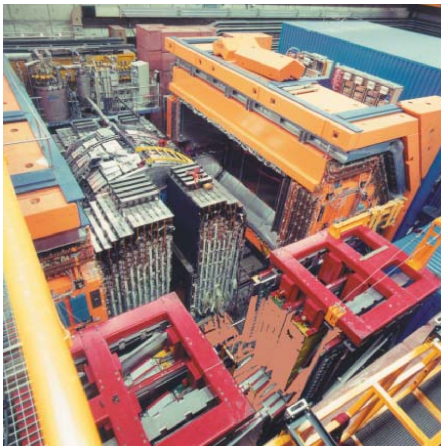
3. LE DÉTECTEUR ZEUS enregistre les particules issues des collisions entre les électrons et les protons de très haute énergie cinétique qui circulent dans HERA. Ultrasensible, ce détecteur haut comme une maison identifie les particules issues du choc en reconstituant leurs trajectoires.
