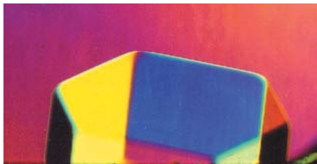
Cristal d'hélium obtenu par compression lente à partir d'un germe.
