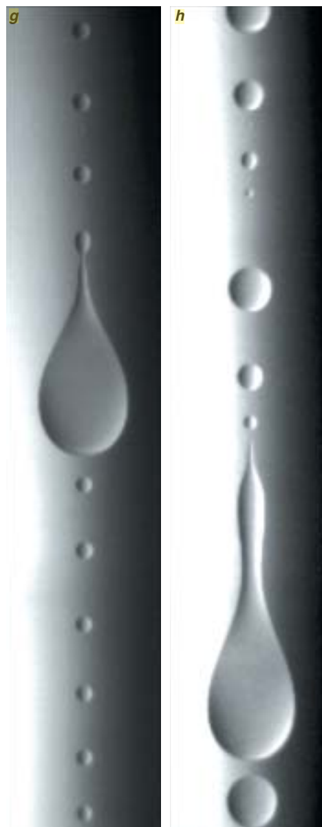
Une goutte d'huile glissant sur un plan incliné prend différentes formes (ovale, en coin, perlante...) suivant sa vitesse, qui augmente ici de (a) à (h). Le mouvement a lieu du haut vers le bas de la figure. L'illusion de relief, obtenue avec une huile et une plaque transparente, est donnée en éclairant la goutte par le dessous avec un fond lumineux non-uniforme.
