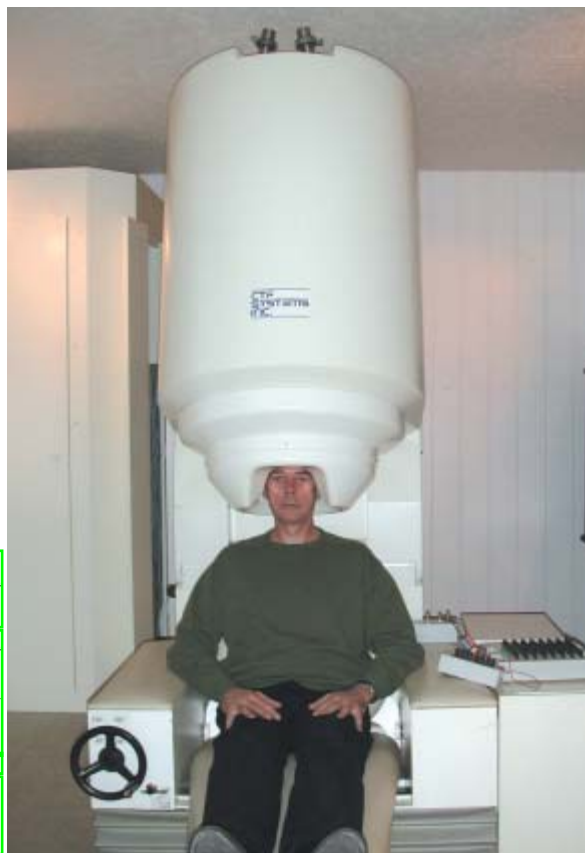
5. LE MAGNETOENCEPHALOGRAPHE de l'Hôpital de la Pitié-Salpêtrière, à Paris. Le casque contient 151 capteurs supraconducteurs maintenus à très basse température grâce à l'hélium liquide contenu dans le réservoir supérieur. Cet instrument est équipé de 64 canaux d'enregistrements électroencéphalographiques, ce qui permet des mesures simultanées de l'activité électrique et l'activité magnétique du cerveau.
