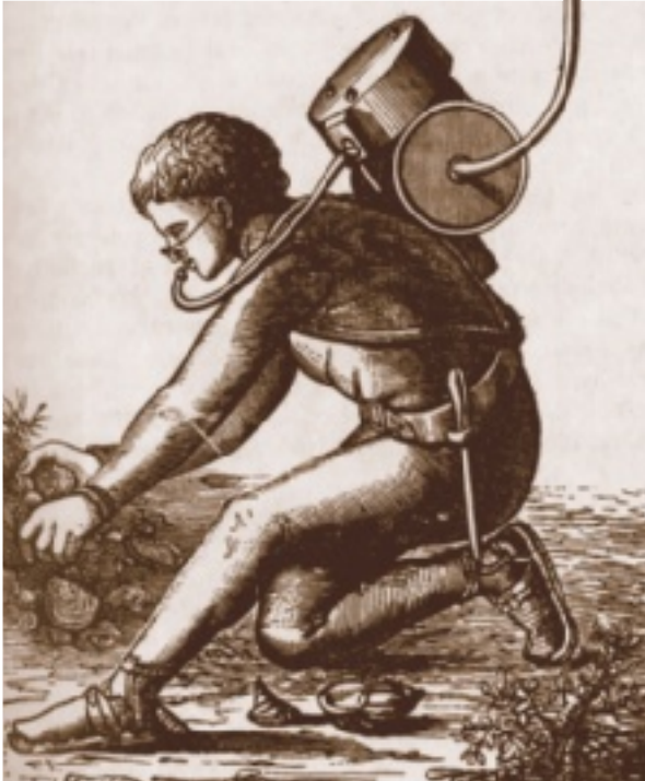
2. Le scaphandre autonome a été mis au point par Auguste Denayrouze et Paul Bert qui développèrent le premier régulateur de gaz. La plongée de loisir apparaîtra un siècle plus tard quand des détendeurs de mélanges respiratoires plus maniables, fondés sur ce premier modèle, seront fabriqués.
