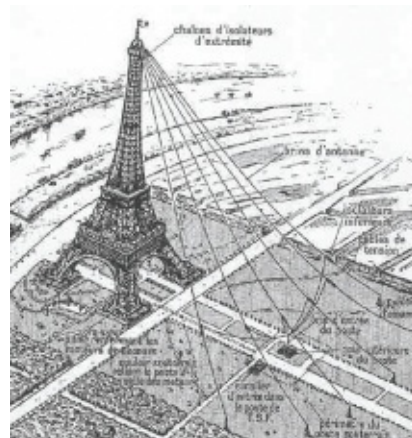
4. L'INSTALLATION RADIO de la tour Eiffel en 1909. La transmission d'informations – notamment l'heure – pouvait atteindre 3 000 kilomètres, et plus de 4 500 kilomètres en 1910.
