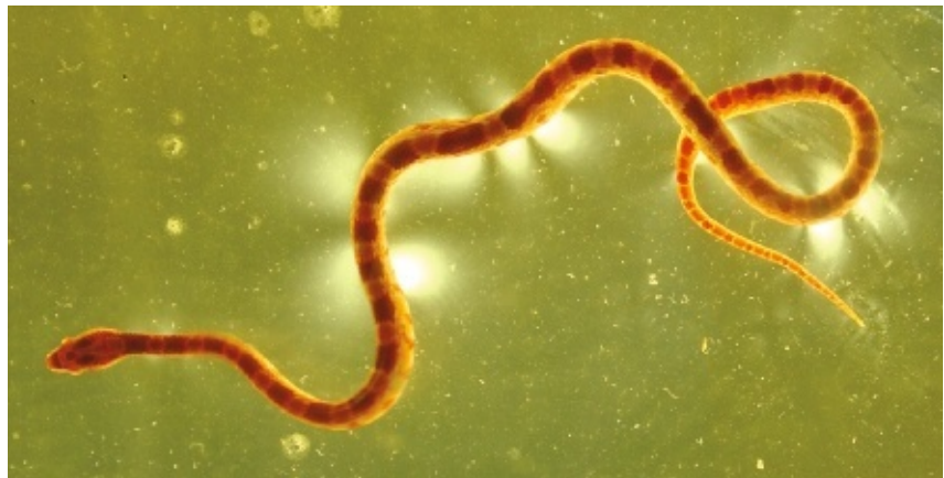
4. UN SERPENT DES BLÉS glissant sur de la gélatine photo-élastique illuminée par dessous et filmé entre des filtres à polarisation croisée. Initialement, l'orientation des filtres empêche la lumière polarisée de parvenir à la caméra, mais quand le serpent appuie sur la gélatine, il y a rotation de la polarisation de la lumière, ce qui permet à la caméra de la détecter (les zones lumineuses sous le serpent). Cette technique visualise les points de contact du serpent avec le sol.
