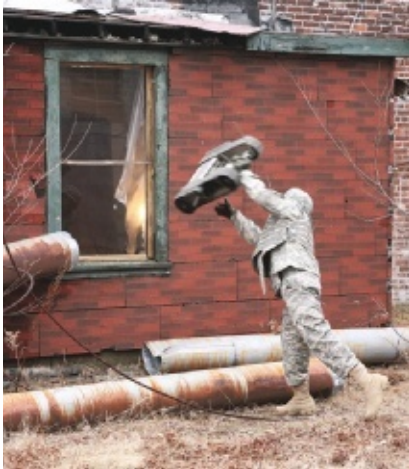
3. UN SOLDAT JETTE UN PACKBOT à travers une fenêtre avant de se mettre à l'abri. Les caméras vidéo du robot lui permettront d'explorer les lieux.
