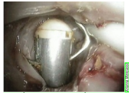
UNE GÉLULE HYBRIDE GUIDÉE par des électroaimants externes se déplace dans le côlon d'un cochon, en utilisant ses pattes pour ajuster sa position et repousser le tissu environnant.
