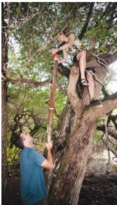
2. LES ARBRES SE SONT RÉVÉLÉS PRATIQUES pour maintenir verticales les carottes de sédiments. Les scientifiques coupaient de minces tranches dans le haut de la carotte, là où les sédiments sont très meubles, pour les emballer et les envoyer au laboratoire.
