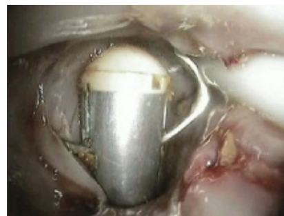
UNE GÉLULE HYBRIDE GUIDÉE par des électroaimants externes se déplace dans le côlon d'un cochon, en utilisant ses pattes pour ajuster sa position et repousser le tissu environnant.
