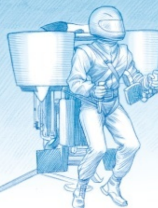
2. LE MARTIN JETPACK met en œuvre deux hélices carénées mues par un moteur à essence et qui expulsent de l'air vers le bas.
