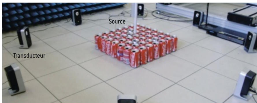
3. UN « CRISTAL » DE 49 CANETTES DE SODA peut osciller suivant 49 modes de vibration différents dont les fréquences s'étalent entre 340 et 420 hertz, alors qu'une canette isolée oscille à 420 hertz. Quand l'une des canettes reçoit un signal acoustique de quelques millisecondes, tous les modes du cristal sont excités et des transducteurs éloignés reçoivent la superposition de ces modes. Après retournement temporel, le signal se concentre sur l'unique canette où était située la source. La résolution atteint \lambda/25 .
