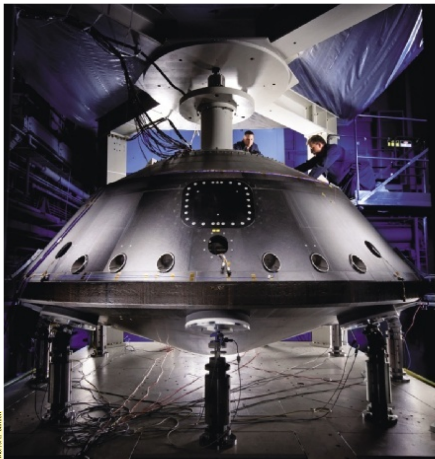
3. LA COQUE DE PROTECTION DE MARS SCIENCE LABORATORY , lancé le 26 novembre dernier, comporte un bouclier de rentrée atmosphérique plus grand que ceux des capsules Apollo .
