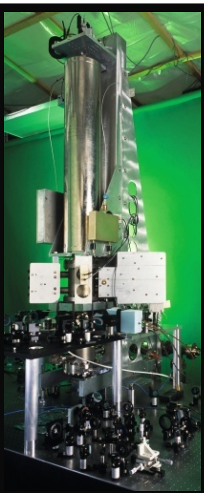
5. LA PREMIÈRE MESURE ATOMIQUE du temps, via la fréquence d'un rayonnement du césium 133, a été réalisée en 1952 avec l'instrument NBS-1 (ci-dessus) du NIST, l'Institut américain des normes et de la technologie. L'étalon actuel du temps civil et des fréquences des États-Unis est mesuré avec une précision de une seconde pour 100 millions d'années par l'instrument NIST-f1 (à droite).
