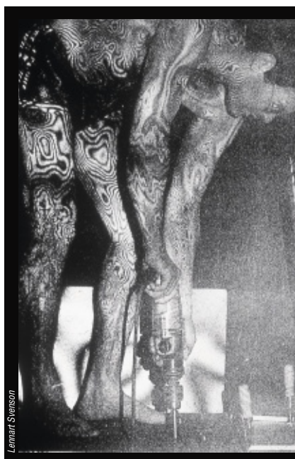
5. DES HOLOGRAMMES DE SUJETS MOBILES peuvent être créés grâce à des lasers à impulsions. L'un des plus anciens montre un homme qui utilise une perceuse ( ci-contre ). Les dessins à sa surface indiquent que l'homme a bougé entre deux flashes du laser lors de l'enregistrement. Cet hologramme ainsi que tous ceux de type Leith-Upatnieks nécessitent des lasers pour être visionnés, sinon la plaque holographique ( ci-dessus ) ne ressemble pas à l'image d'origine.
