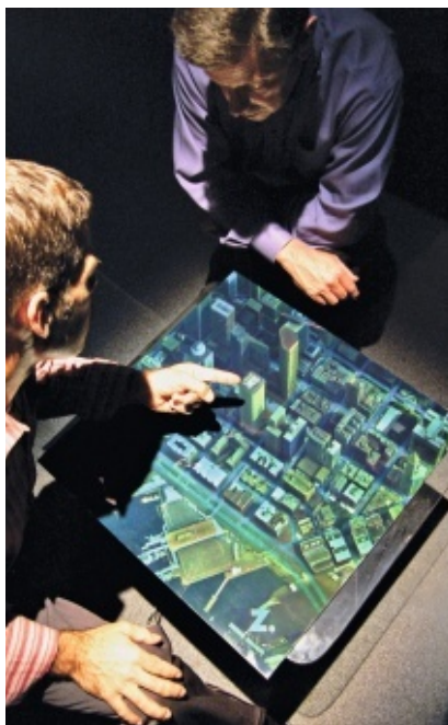
8. CET HOLOGRAMME présente une vue en couleur d'un modèle infographique de Seattle. Le motif a été créé par ordinateur. L'utilisation de l'informatique rend la synthèse d'hologrammes plus rapide, même si la quantité de calculs nécessaires reste une difficulté.
